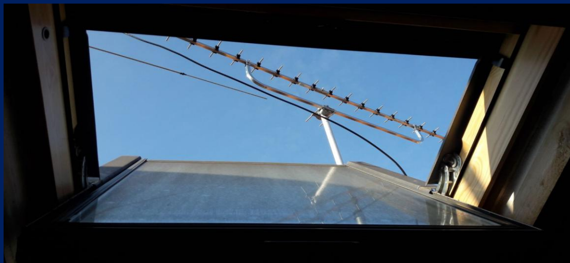
Antenna Yagi 23 a elementi, fuori dall'abbaino di casa mia (1296 MHz)
