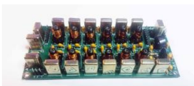
Economico filtro passa banda a 6 bande per ricevitori
