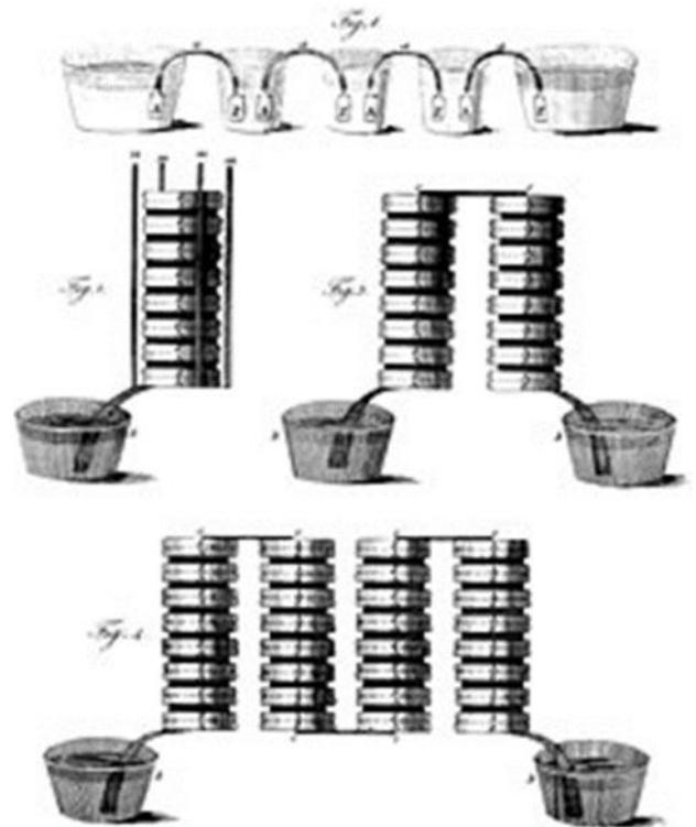
Disegni della pila a corona di tazze e varie configurazioni di pila a colonna, inclusi nella lettera inviata da Volta a sir Joseph Banks per annunciargli la sua invenzione
